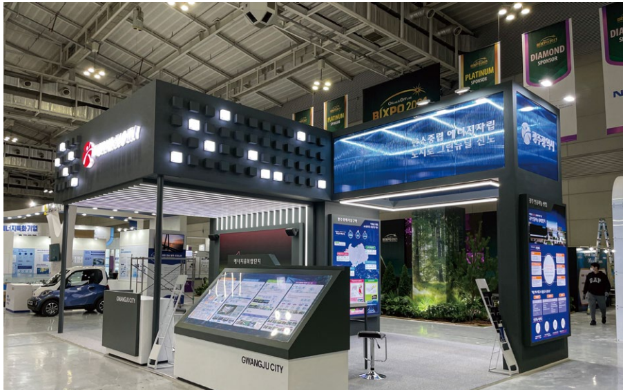
△ 부스의 반 이상을 덮고 있는 솔리드한 타워에, LED 큐브라이팅 및 반투명 폴리카보네이트 재료를 사용함으로써 자칫 무거울 수 있는 느낌을 상쇄시켜줌
